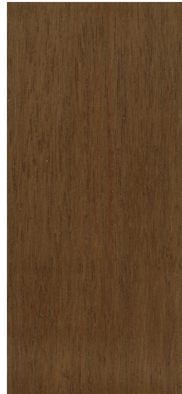
Débit sur faux quartier
